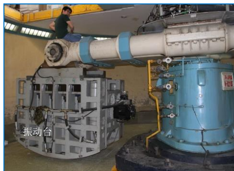
图 1 水平+垂直双向离心机振动台 Fig.1 Horizontal and vertical centrifuge shaking table
